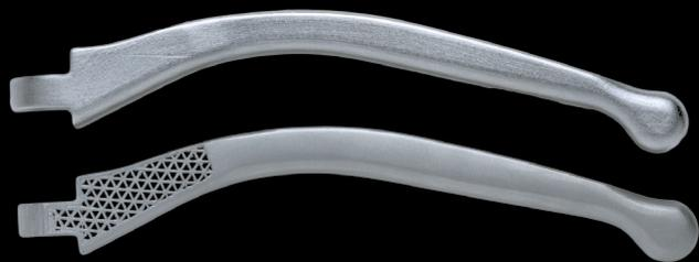
Questa soluzione consente la creazione di geometrie uniche come celle a nido d'ape chiuse all'interno della parte. Le parti possono essere stampate come le strutture delle ossa – un nucleo a celle interno chiuso avvolto in un guscio esterno solido. Questa geometria non è realizzabile utilizzando processi tradizionali di lavorazione sottrattiva.
