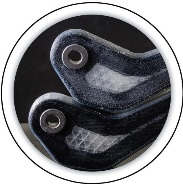
La Mark Two utilizza il processo brevettato di Fabbricazione a Filamento Continuo (CFF) per rinforzare le parti in nylon stampate in 3D con depositi di filamenti continui di fibra di carbonio, Kevlar e fibra di vetro, sagomati e ottimizzati automaticamente.
